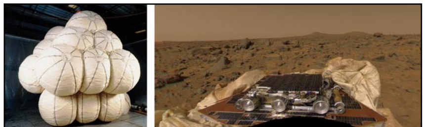
5. ábra. A Pathfinder űrjármű légszáka felfújt állapotban és leszállás után a Mars felszínén
